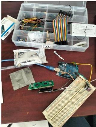
Figura 1. Sistema de adquisición de presión atmosférica y temperatura instrumentado con un Arduino UNO y el sensor BMP280.
