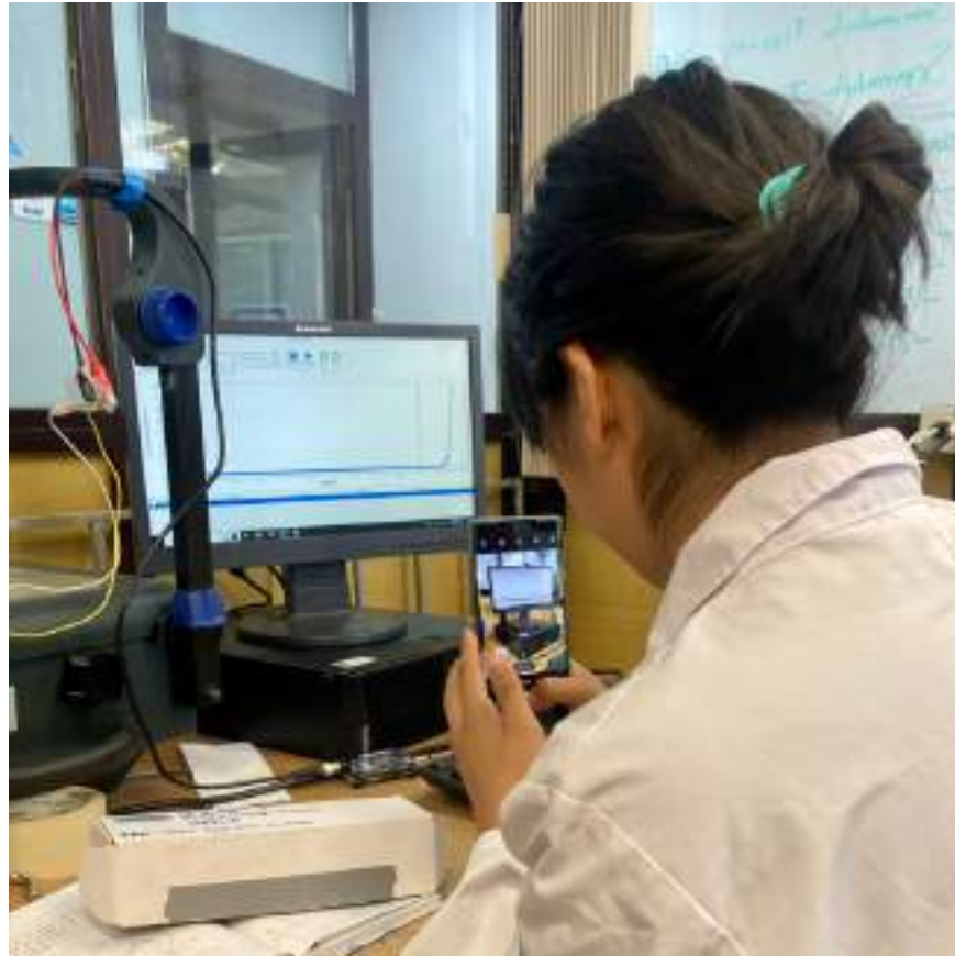
Alumna de servicio social BUAP (Mariana) realizando su primer curva I-V de un diodo 1N4007 con el \mu SMU
