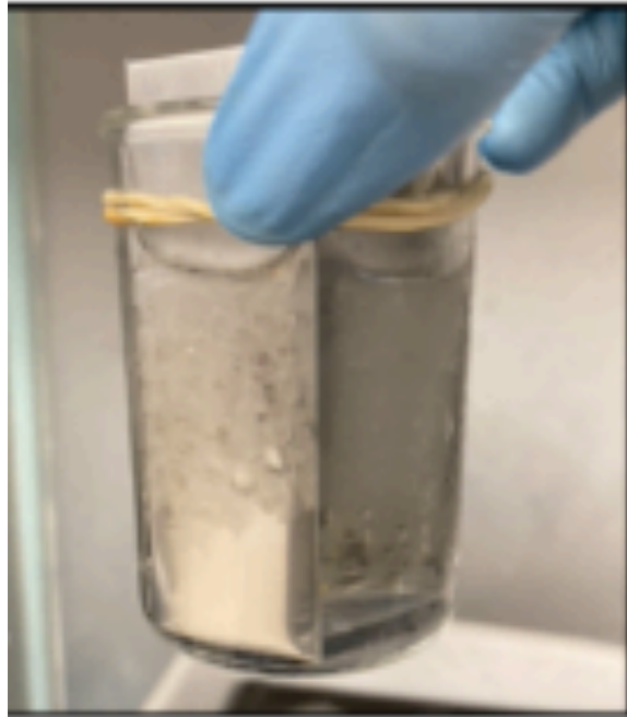
Solución de reacción inicial con sustratos de acero inoxidable
