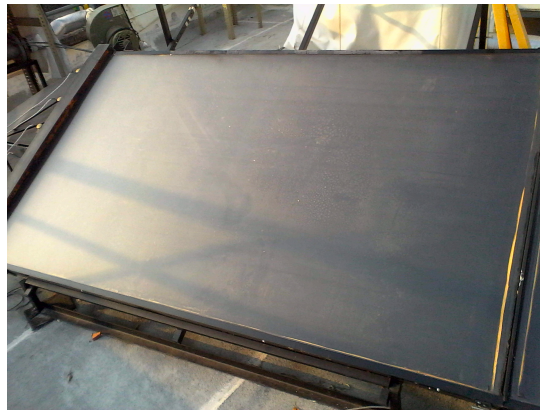
Figura 4.1: Un calentador solar de aire de ductos rectangulares.
