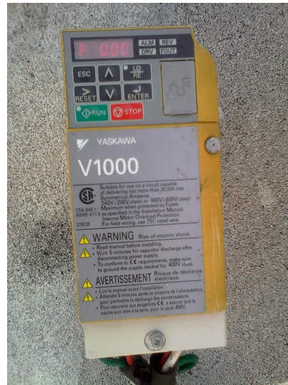
Figura 4.9: Variador de frecuencia.
